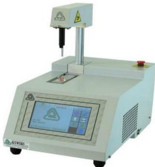
**CARACTERÍSTICAS****Volumen :** 2 a 2,5 ml de leche**Capacidad :** 25 muestras / hora**Duración :** 2 minutos**Repetibilidad :**  $\pm 0,002^{\circ}\text{C}$ **Resolución :**  $\pm 0,0005^{\circ}\text{C}$
