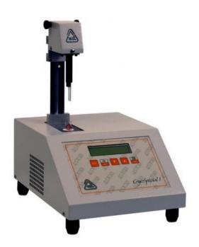
CryoSpecial 1 es un crióscopo muy accesible para la rápida y exacta determinación de la variación del punto de congelación de leche/nata y del porcentaje de agua añadida, con prestaciones analíticas según las normas de referencia IDF-ISO 5764:2009 y AFNOR.
